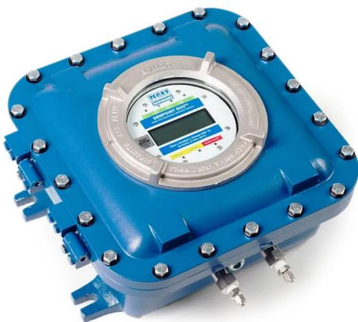
Il possède une précision de  $\pm 0.5^{\circ}\text{C}$ , différencie les points de rosée hydrocarbure et eau, et fournit des mesures extrêmement précises. Il est basé sur le procédé breveté de spectroscopie Infrarouge CEIRS™ (Chilled-Evanescence Infrared Spectroscopy).
