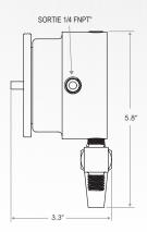
Si une sortie est nécessaire à gauche, retourner le GENIE et utiliser le port "BYPASS" comme entrée, car l'échantillon doit entrer par le port du haut.
